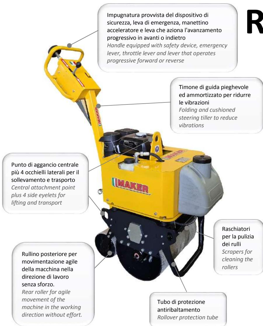
Ideale per compattare qualunque tipologia di terreno e asfalto. La struttura è semplice ed economica, ma garantisce elevate prestazioni. Molto compatto, permette di lavorare in parallelo ai marciapiedi e in piccoli spazi. La sua alta forza centrifuga direttamente sul rullo lo rende adatto a sostituire anche macchine di peso superiore con lo stesso rendimento ed una maggiore manovrabilità.
